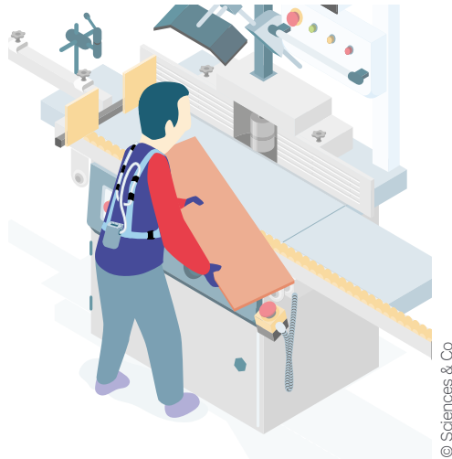
▲ Opérateur portant le capteur et la pompe de prélèvement des poussières de bois.
