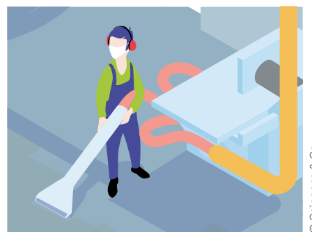
▲ Buse d'aspiration raccordée au système de ventilation de l'atelier.
